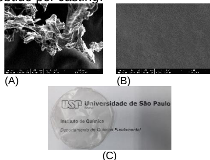
Figura 3. Imagens MEV (A) da glucana extraída, (B) do filme formado e (C) Fotografia do filme obtido por casting .
