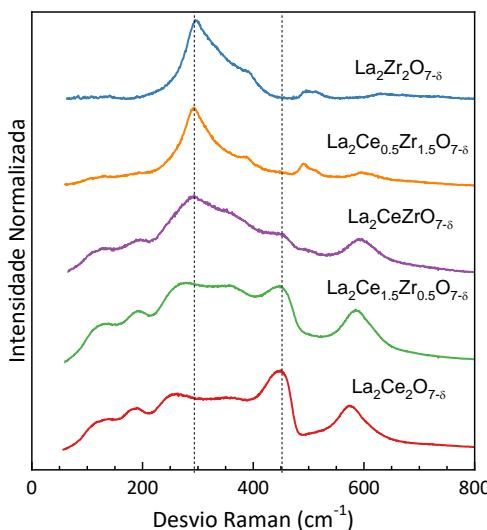
Figura: Espectro Raman das amostras  $\text{La}_2\text{Ce}_{2-x}\text{Zr}_x\text{O}_7$ .
