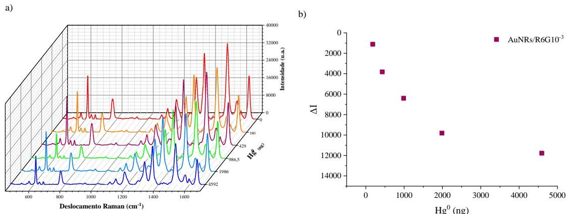
Figura 1. a) Redução da intensidade SERS da Rodamina 6G em função da concentração de  $Hg^{0(g)}$  de 180 a 4952 ng; (b) Curva analítica para a variação da intensidade SERS da banda 1509,74  $\text{cm}^{-1}$  da Rodamina 6G em função do aumento da concentração de  $Hg^{0(g)}$ .
