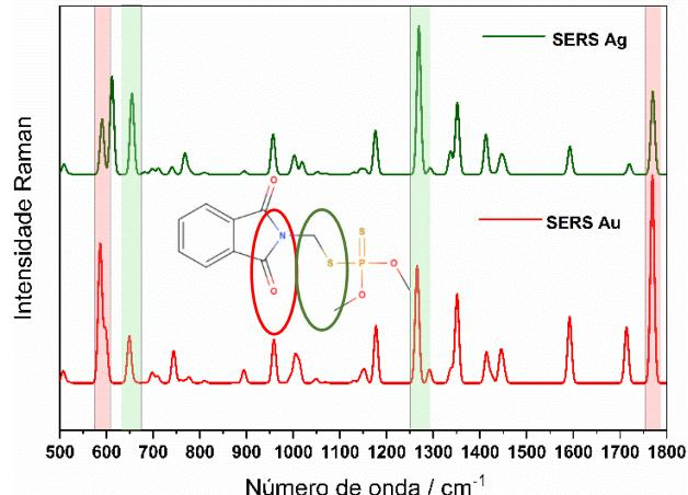
Figura 2. Espectros SERS Ag e Au teóricos, obtidos pelo cálculo DFT
