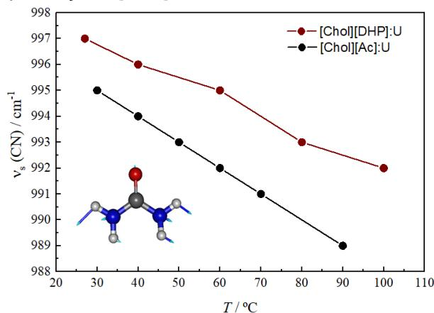
**Figura 1.** Deslocamento da banda de estiramento simétrico CN da ureia em função da temperatura durante o aquecimento dos DESs [Chol][Ac]:U e [Chol][DHP]:U.
